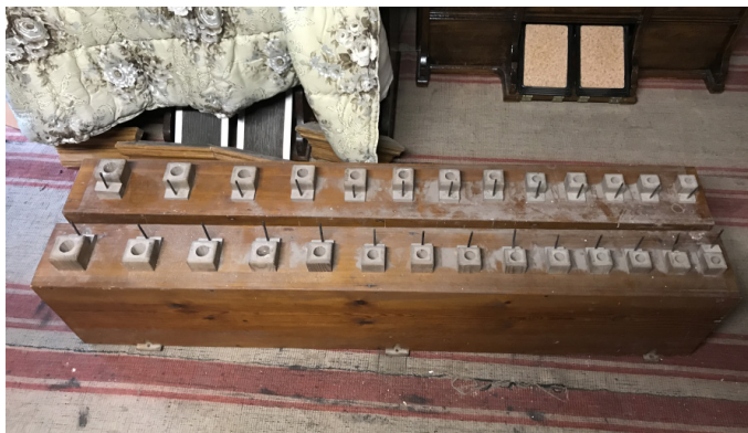
Piščalni blok (C in CIS) registra Bombarde 16' iz starih orgel iz cerkve sv. Štefana v Vipavi, F. Goršič, op. 57, 1892. (Arhiv Uroša Kovača)
